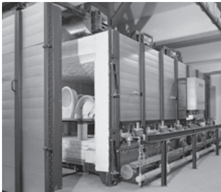
Four à céramique avec régulation de température par séquenceur
