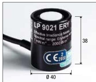
**LP 9021 ERY:** Sonda radiometrica per la misura dell'**IRRADIANIMENTO TOTALE EFFICACE** ( $W_{eff}/m^2$ ) ponderato secondo la curva di azione UV (CEI EN 60335-2-27) completa di modulo SICRAM. Campo spettrale: 250 nm...400 nm, diffusore per la correzione del coseno in quarzo. Campo di misura:  $0.1 \cdot 10^{-3} W_{eff}/m^2 \dots 2000 W_{eff}/m^2$ .
