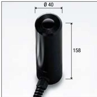
**LP 9021 LUM6:** Sonda per misure di **LUMINANZA**, misura nel campo da 1 a  $1999 \times 10^3$  candele/m<sup>2</sup>. Angolo di misura 2°. Filtro CIE per la correzione della risposta secondo CIE n° 69 - UNI 11142
