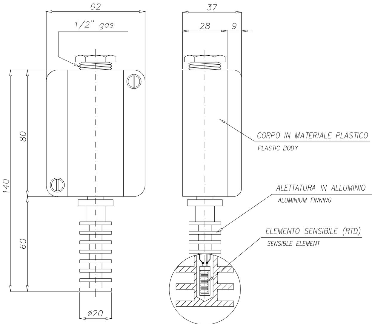
ZAMA SENSOR s.r.l. / DISEGNATORE : 544 / APPROVATO DA : 003 / DATA : 10/11/1998 / REVISIONE N° 00.00 DEL 10/11/1998
